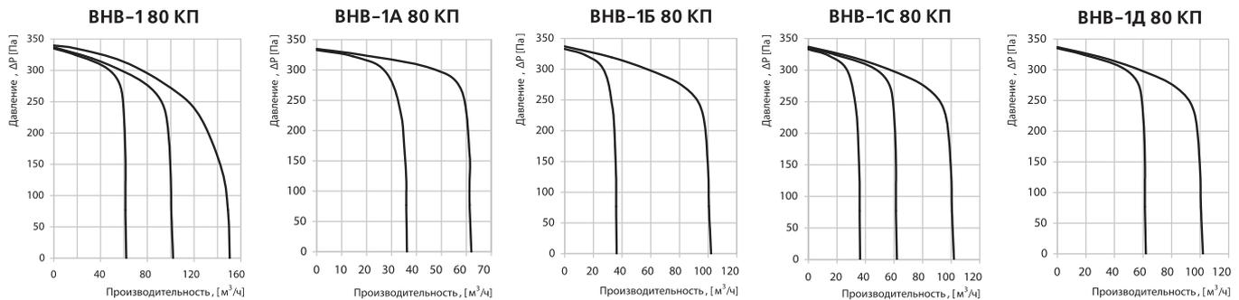
Крутая характеристика отражает высокий потенциал вентиляторов ВНВ по давлению при сохранении постоянного расхода воздуха, позволяя при этом одновременно работать множеству вентиляторов в одной вентиляционной шахте:
